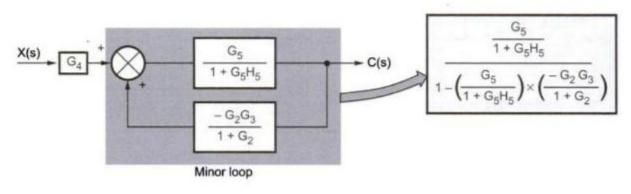
$$\frac{C(s)}{X(s)} = \frac{G_4G_5(1+G_2)}{1+G_5H_5+G_2+G_2G_5H_5+G_2G_3G_5}$$
